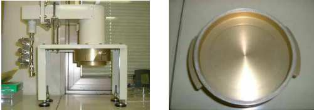
Figure.6 : Guide d'onde cylindrique utilisant le mode TM_{01} , et le court-circuit métallique où est placée la boîte de Pétri [I. 72]
