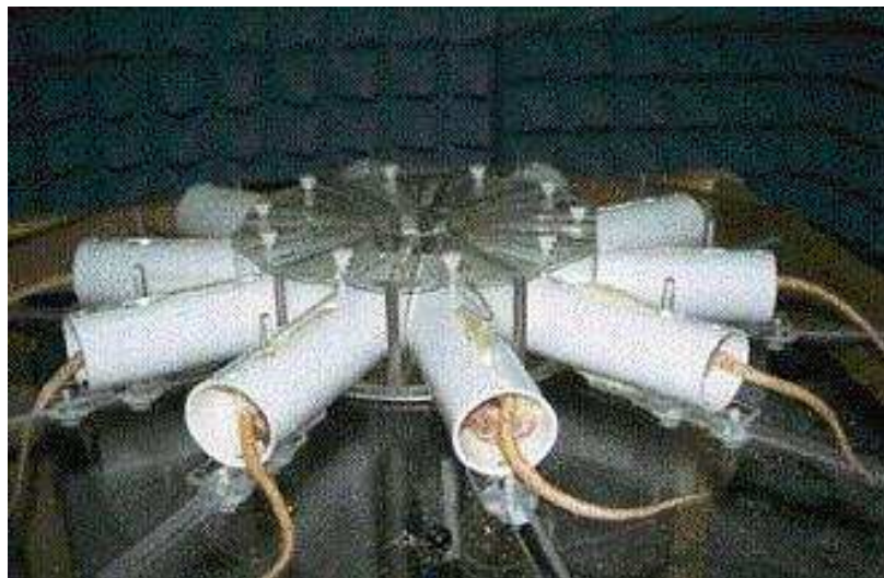
Figure 30 : Carrousel pour l'exposition de 10 rats à 835 et 900 MHz
