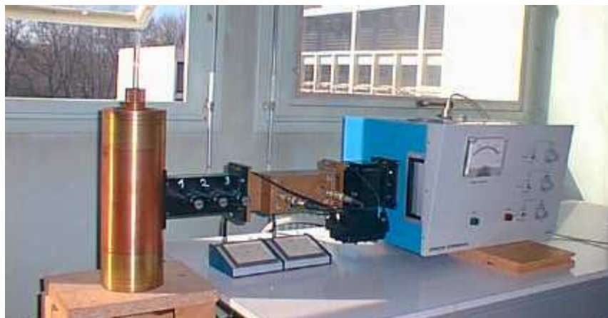
Figure 7 : Système d'exposition avec cavité cylindrique résonante pour illumination d'un tube à essai [I. 73].
