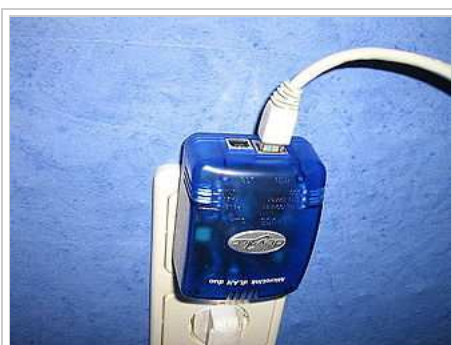
Exemple de boîtier CPL domestique installé
